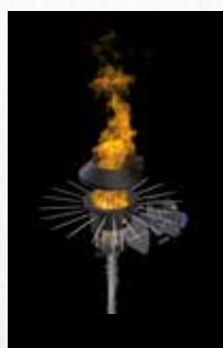
Un système breveté qui garantit une combustion totale. Grâce à la rotation du creuset à chaque allumage et chaque extinction, le poêle effectue un nettoyage autonome en quelques secondes avec une évacuation uniforme des résidus dans le compartiment à cendres dans le but de réduire la fréquence de nettoyage et de maintenir les performances de l'appareil. La gamme Kline n'inclut pas cette technologie mais dispose d'un creuset similaire non rotatif à nettoyer plus régulièrement.
